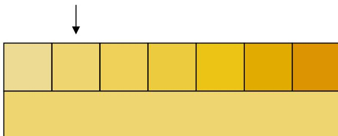
如果样品色调与颜色标准不接近，采取目视法匹配是非常主观的。下表中，用箭头标出了样品最接近的颜色，自动仪器预测出的即此颜色值。在视觉上，由于色调差，所选值与右侧相邻的下一标准很接近。PFXi 仪器给出的该样品的偏色因子为 5.
