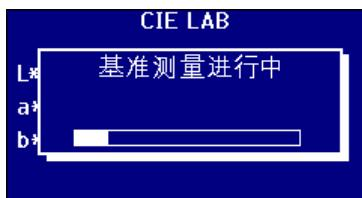
完成基线测量后，仪器即返回按 **ZERO** 键之前的显示屏幕。
