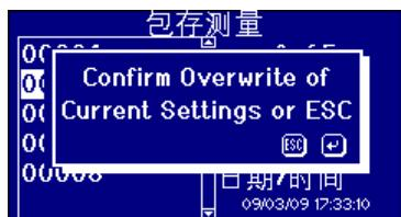
如果当前仪器设置于已存储的测量不同，需要将设置变更为与已存储测量一致。
