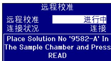
基线测量完成后，显示会请求溶液测量。溶液号由包代码确定。
