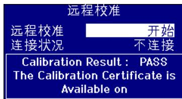
测量验证完成后，校正伺服器将确认信息发送回仪器。同时将含有校准证书的邮件发送到在校准网站注册时输入的邮箱地址。
