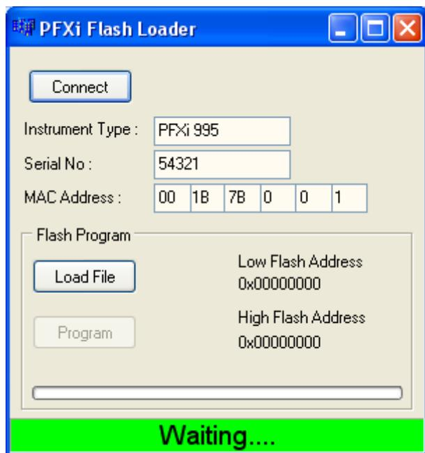
点击“加载文件”按钮，转到新的闪存文件（“PFXi\_100xx.flash”）。文件加载需要几秒钟时间。正确加载文件后，“程序”按钮变为可用状态并显示有固件的“高”地址（仅供参考）：
