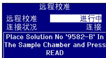
仪器会请求依次测量校准包内的溶液，应测量全部溶液。应将使用后的溶液倒掉，不准再倒回瓶内。
