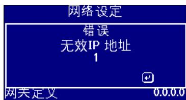
如果 IP 地址输入有误，将显示以下屏幕信息。按 **■** 键退出屏幕，重新输入所需数值。
