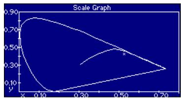
该图显示 CIE xy 色度图中的曲线。测定的样品显示为“**x**”。
