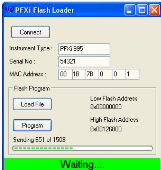
运行完成后，液晶显示屏会显示“升级成功，重启仪器”——关闭仪器重启。确认仪器启动画面的软件为正确版本（应与文件名版本部分相符）。
